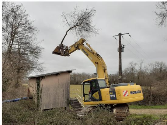
*Pelle avec sécateur hydraulique*
